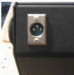
Разъём XLR-вилка для подключения управления DMX-512 или управляющего-питающего напряжения 12В .
