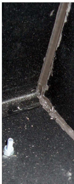
Все стыки проклеены термостойким герметиком. Это предотвращает проникновение пламени в зарядный отсек. Переборка между отсеками защищает баллон от нагрева и пламени.
